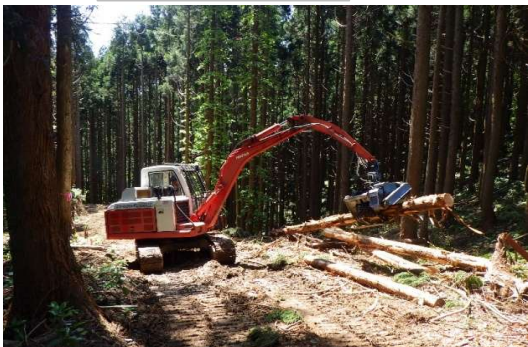
プロセッサで造材（枝払い・玉切）
